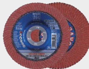
Discos de láminas lijadoras POLIFAN A SGP CURVE ALU para el mecanizado de cordones de soldadura en ángulo (el único disco de láminas lijadoras con láminas en el contorno y un recubrimiento desarrollado especialmente que impide la adherencia de virutas)
